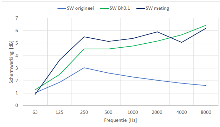
Figuur 17 Berekende en gemeten gemiddelde schermwerking van alle microfoon posities.
