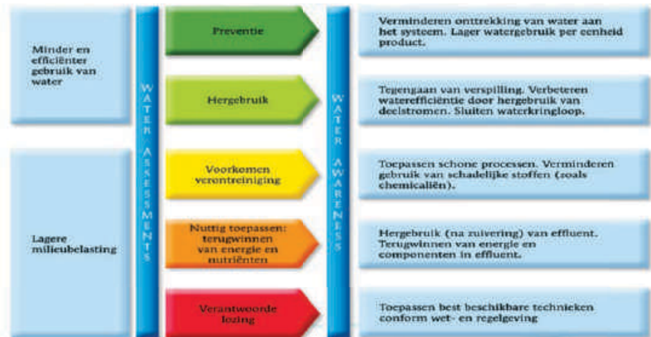
Figuur 18. De ladder voor duurzaam industrieel watergebruik
