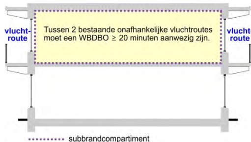
Figuur 2.62 Bestaande onafhankelijke vluchtroutes
