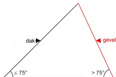
figuur 2.80 Onderscheid dak en gevel (volgens ISSO 75.1)
