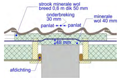
figuur 2.45 Standaarddetail bouwmuur voor pannendak
