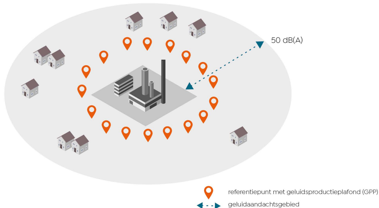
Afbeelding 1: een industrieterrein met geluidproductieplafonds in vereenvoudigde vorm
