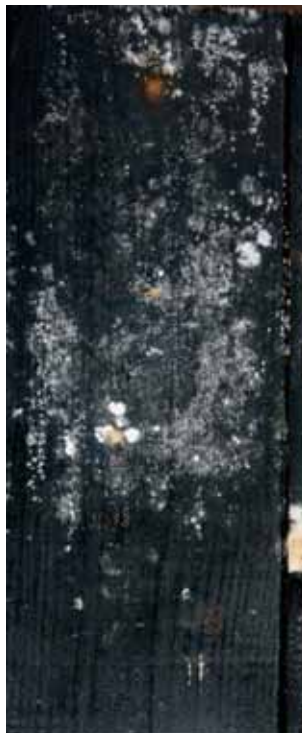
uitloggen brandvertrager door coating
