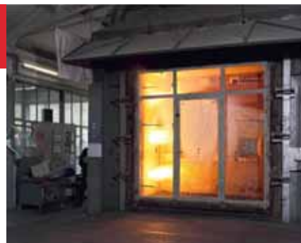
Start brandproef van een enkele deur met twee zijlichten en een bovenlicht.
