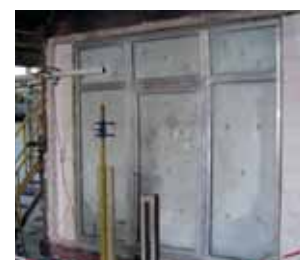
Testen in de praktijk van speciaal voorgespannen geharde (gelaagde) beglazingen en opschuimende beglazing
