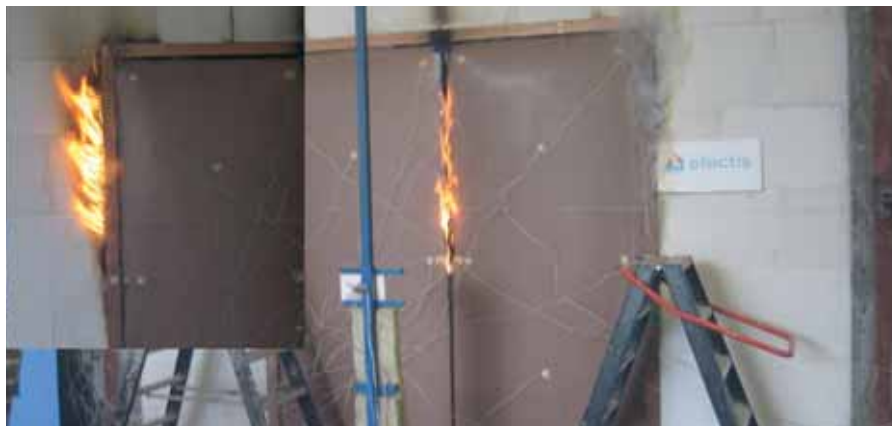
Einde brandproef van een houten dubbele deur na 37 minuten.
