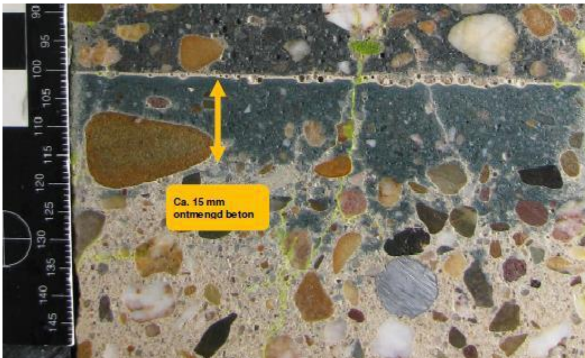
Figuur 20: Ontmenging van beton bovenin de breedplaat. [025.d]
