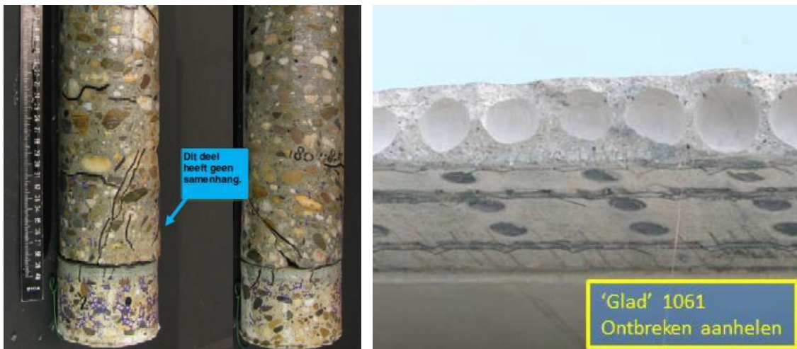
Figuur 14: Geen hechting op contactvlak en niet doorlopen van scheuren in een boorkern (links) [025.d] en een voorbeeld van een glad contactvlak waar de breedplaat is onthecht van de druklaag [024].
