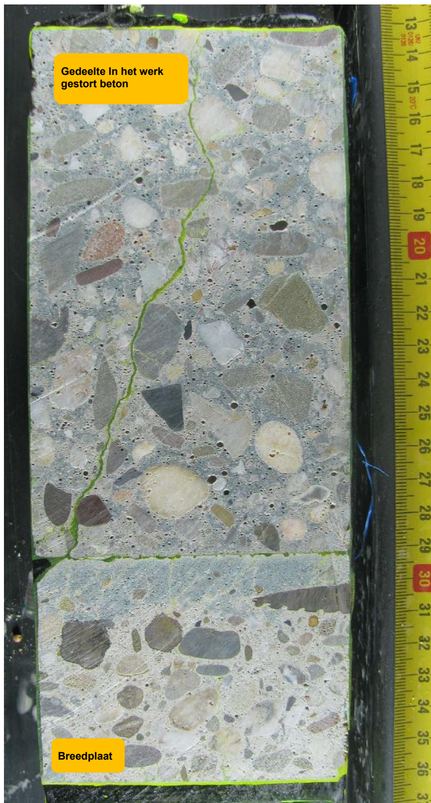
Foto: De langsdoorsnede van een gedeelte van het in het werk gestort beton en de breedplaat is onder slaglicht gefotografeerd. Luchtbellen tekenen zich hierbij donker af.
