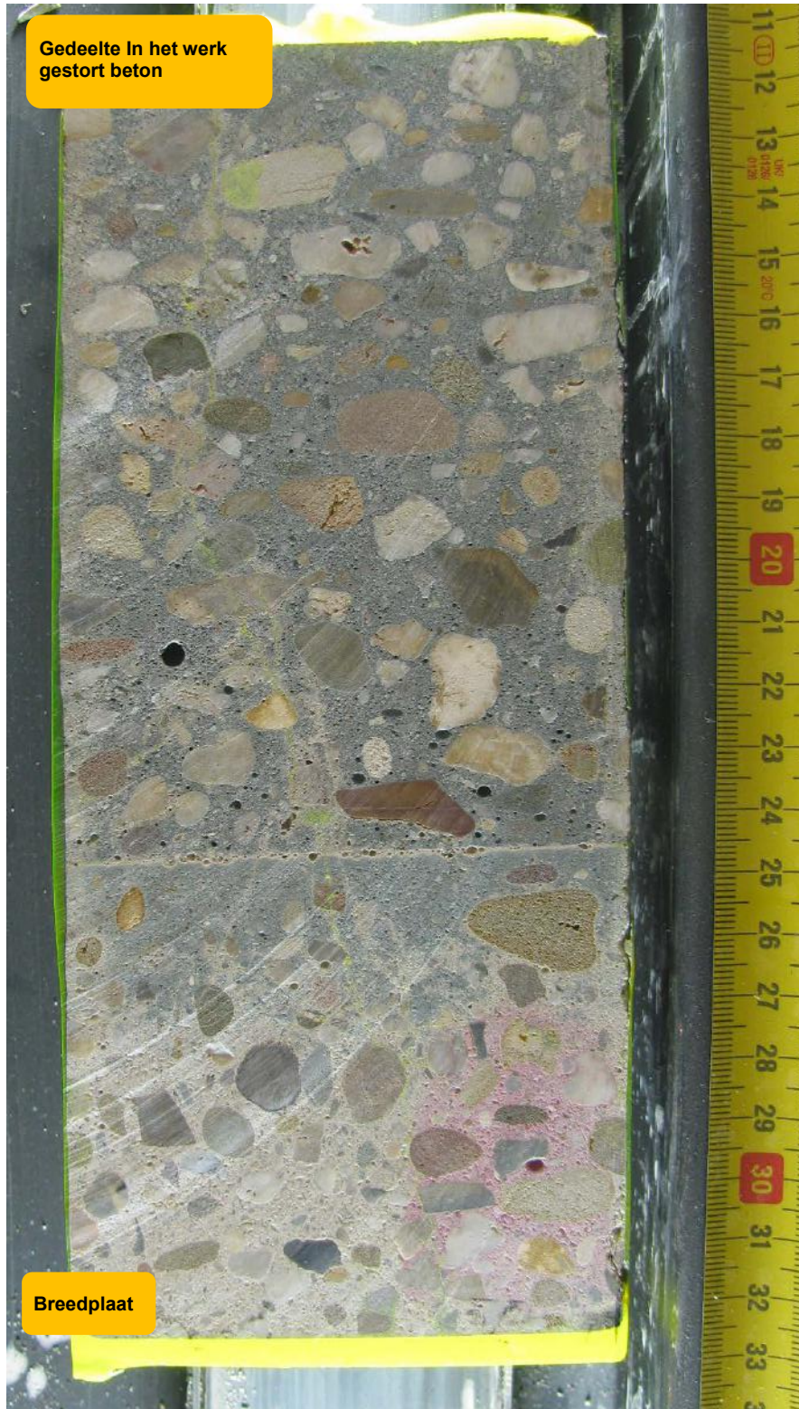
Foto: De langsdoorsnede van een gedeelte van het in het werk gestort beton en de breedplaat is onder slaglicht gefotografeerd. Luchtbelletjes tekenen zich hierbij donker af.
