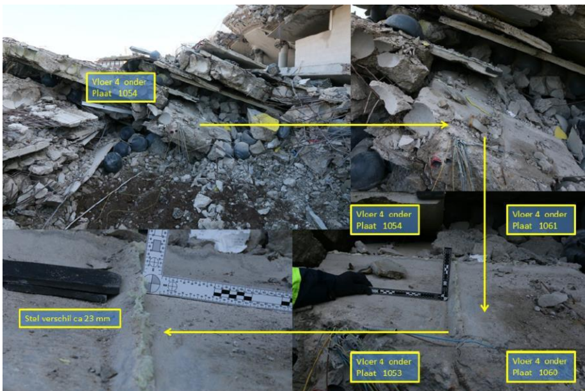
Figuur 21: Mogelijk verschil in plaatdikte. [024]
