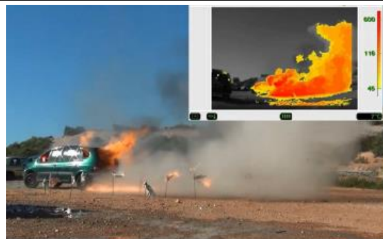
Foto 2: experiment voertuigbrand met waterstof. Aix en Provence, 2014 - Fakkel bij waterstofvoertuig (700bar) - Zichtbare vlam is klein deel van grote onzichtbare vlam - Totaal duurt vlam/afblazen +/- 30 seconden. Onder hoge druk (veel geluid >140dB)
